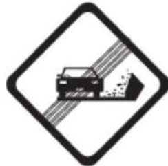
P34 FIN ZONA DE DERRUMBES
