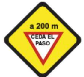
P 33(b) PROXIMIDAD DE SEÑAL RESTRICTIVA(paso)
