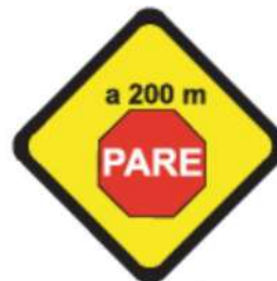
P 33(a) PROXIMIDAD DE SEÑAL RESTRICTIVA(pare)
